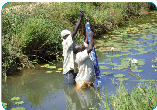
Photo : Installation du niveau à eau pour lire le niveau d'eau dans le canal arroseur.
